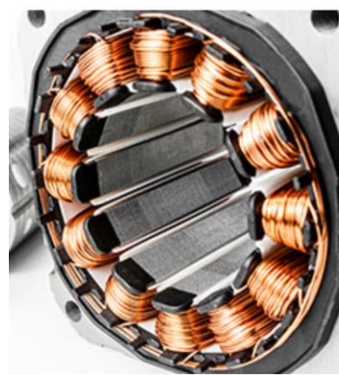
Bobine din cupru concentrate pe poli
